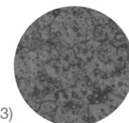
Unser Lagerstahl „SS“ ist der am häufigsten verwendete Lagerstahl für Miniaturkugellager. Er ist ein martensitisch legierter Stahl mit höherem Kohlenstoffgehalt. Er wird in der Industrie häufig für Schneidwerkzeuge aller Art verwendet, insbesondere für chirurgische Anwendungen.
