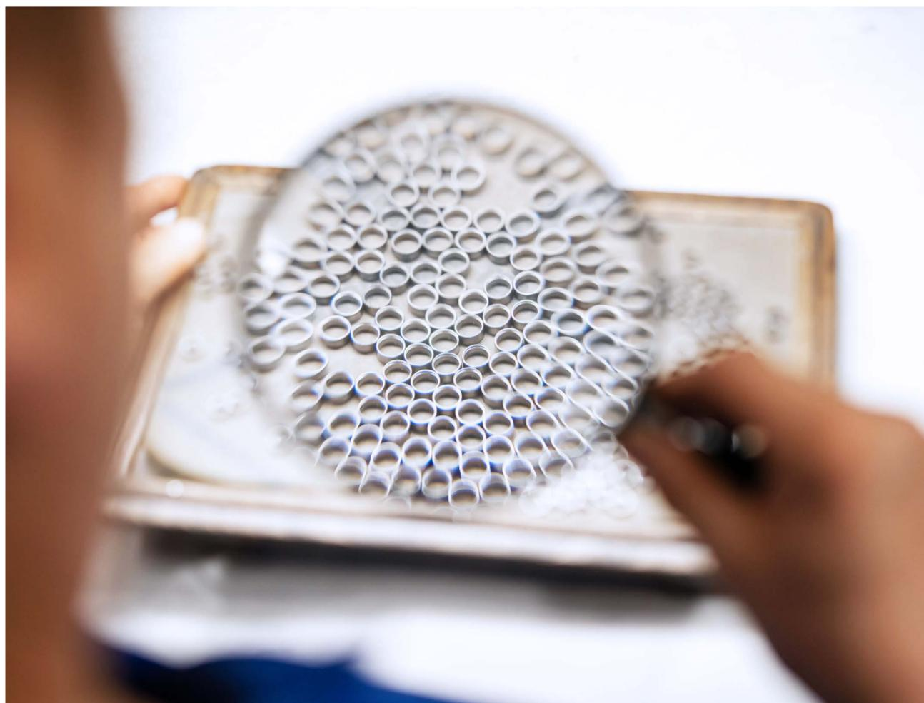
↑ Kugellager-Außenringe bei der Sichtprüfung während des Herstellungsprozesses
